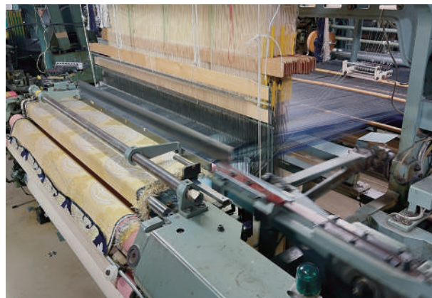
2 電子ジャガード織機による製作
