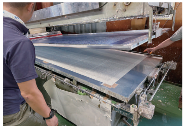
2 シルクスクリーン大型印刷機による刷り工程
