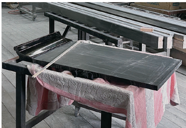
1 漆素地調整作業状況
