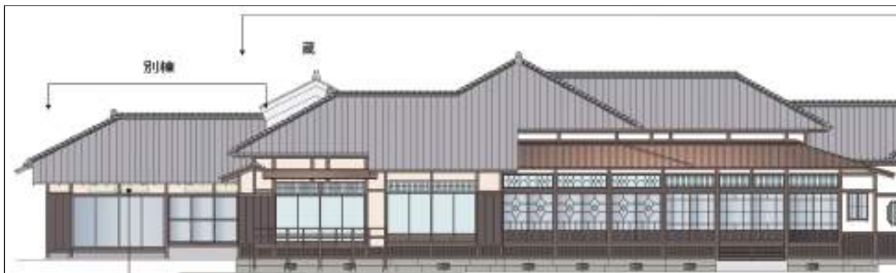
図 7-56 外部漆喰塗り分け図（南面）
