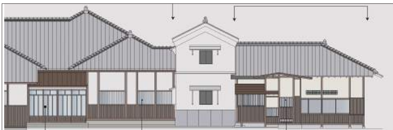
図 7-58 外部漆喰塗り分け図（北面）
