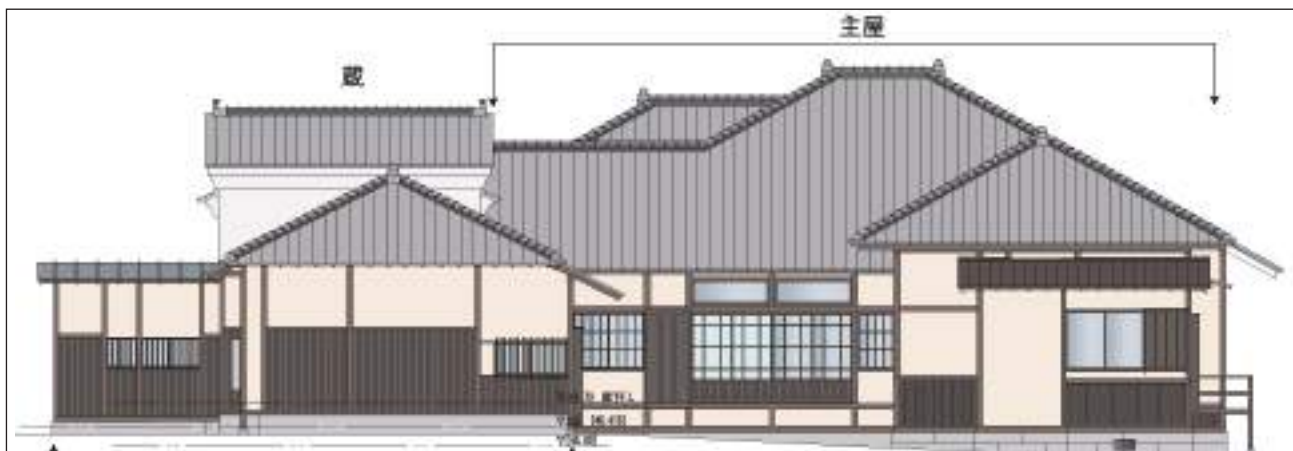
図 7-57 外部漆喰塗り分け図（西面）
