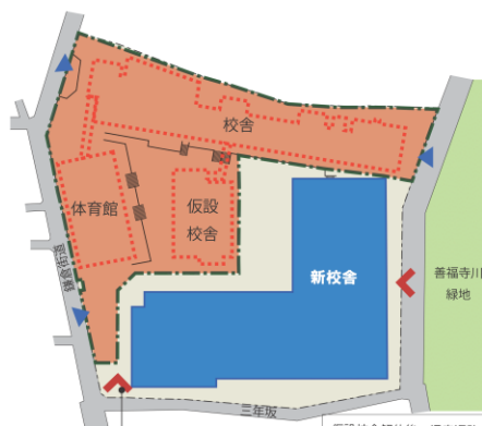
STEP5 仮設校舎・既存校舎・体育館解体 令和6年4月～令和6年12月
