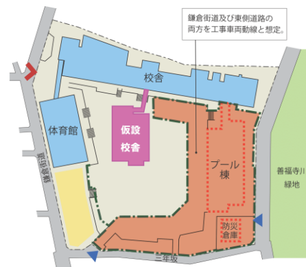
STEP3 プール棟他解体 令和3年7月～令和3年12月
