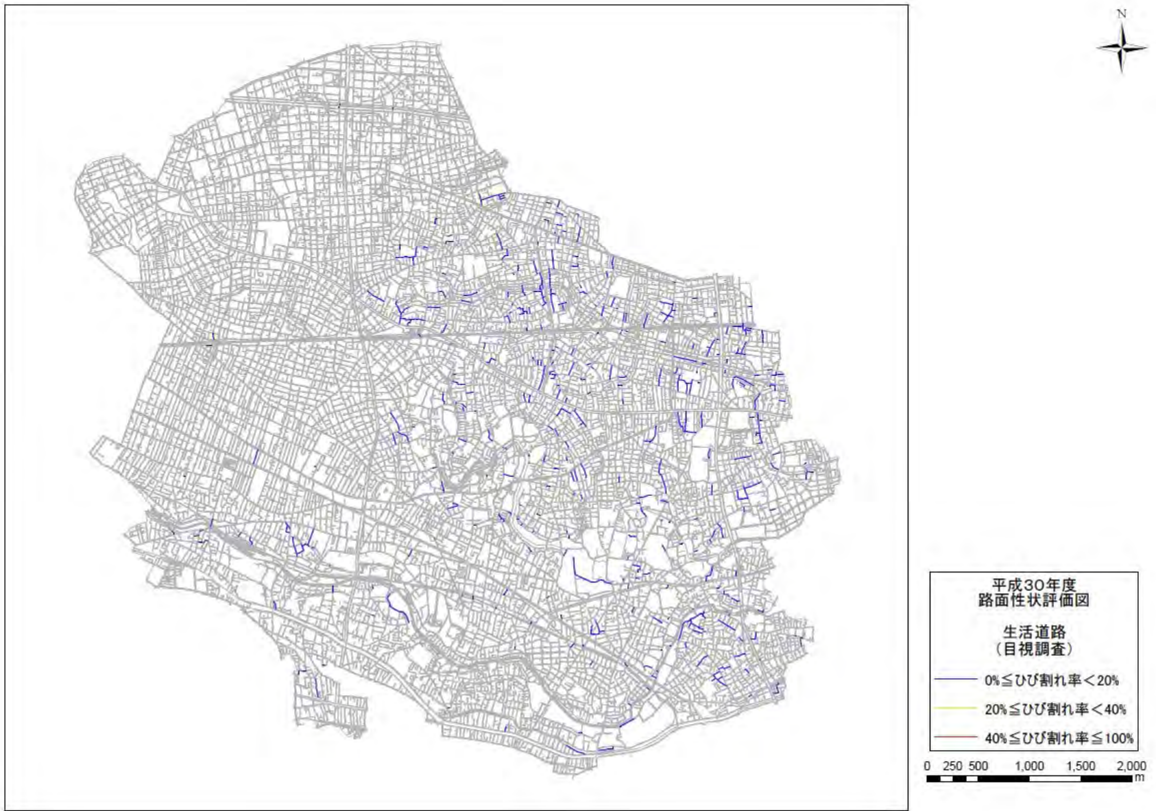
図 2.10 路面性状評価図（生活道路目視調査）
