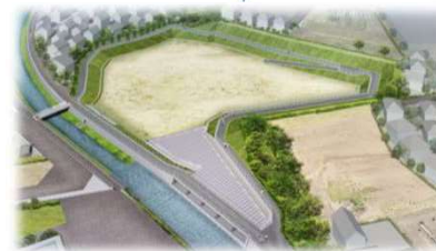
⑨下谷橋調節池 旧落合川敷地等（東久留米市） 規模：約9,500m 3 ※対策強化流域外
