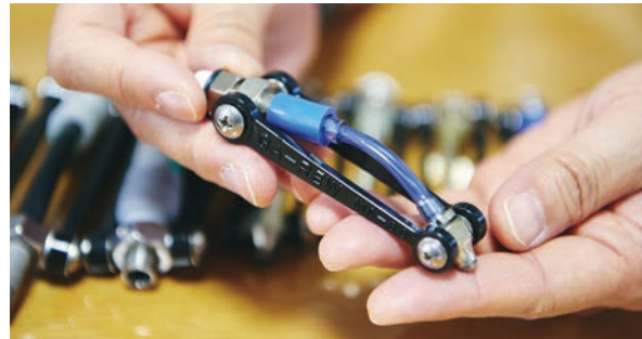
2つのリンクがスライダー(ホース)を挟み込む形状のメカスイングノズル。
