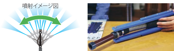
噴射の勢いでトグル機構が作動し、ノズルが左右に振れる。もともとの用途は海賊撃退の放水ノズルだった。
