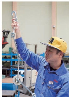
ブランコの鎖部分はねじれにくく、絶対に外れないことが大前提となる条件。設計上はもちろん、実際に人の手でも必ず確認。
