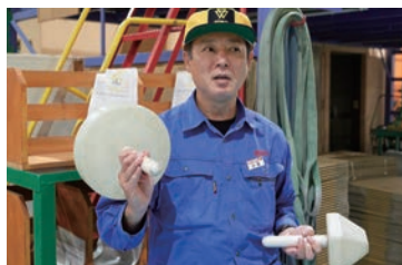
羽村工場的小倉さん。手に持つのは、子どもの頭部や胴体のサイズを示す点検器具。遊具の隙間に体が挟まるなどの事故を防ぐための検査に用いる。
