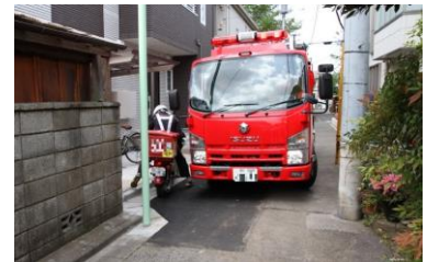
突出電柱の事例
