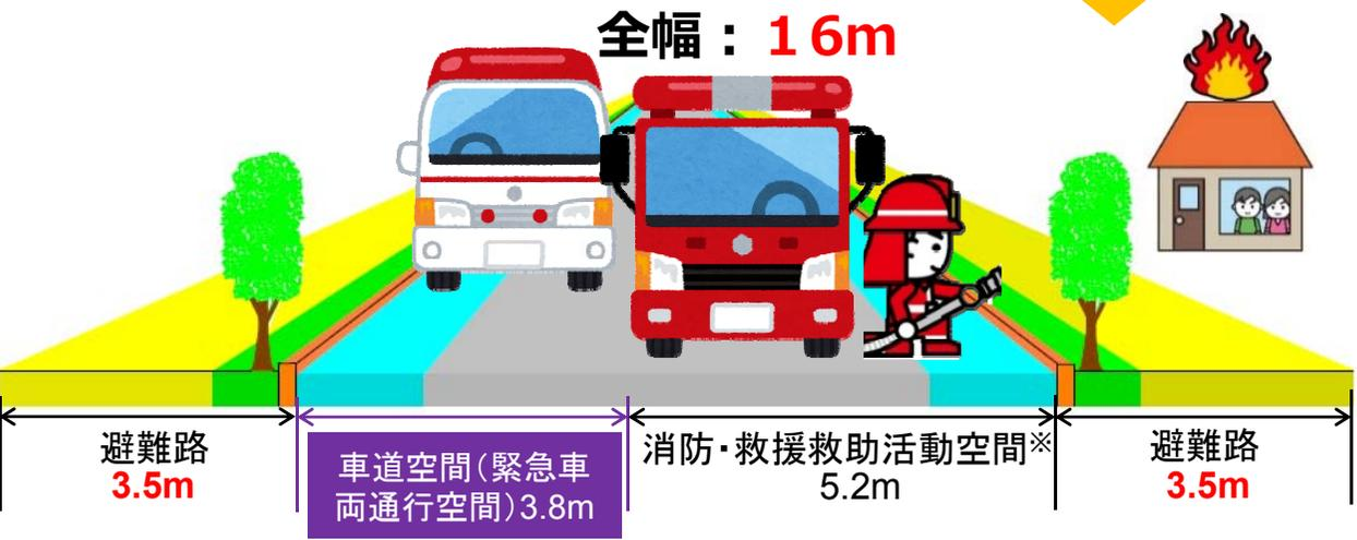
消防車(はしご車)の作業空間= 車体幅(2.5m) + 左右アウトリガ一張出し(1.35m × 2) = 5.2m
