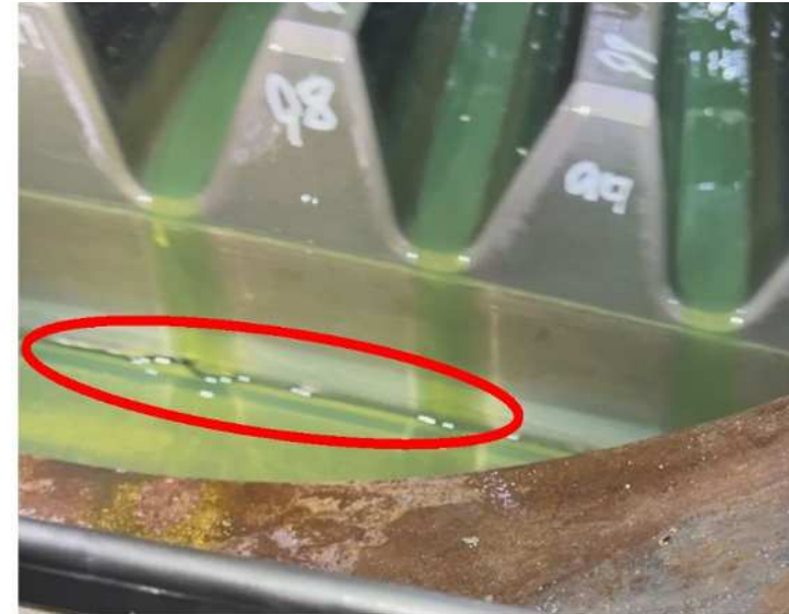
大ギヤの点検結果 （変状状況②）
