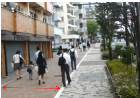
歩道有効幅員約3.5m
