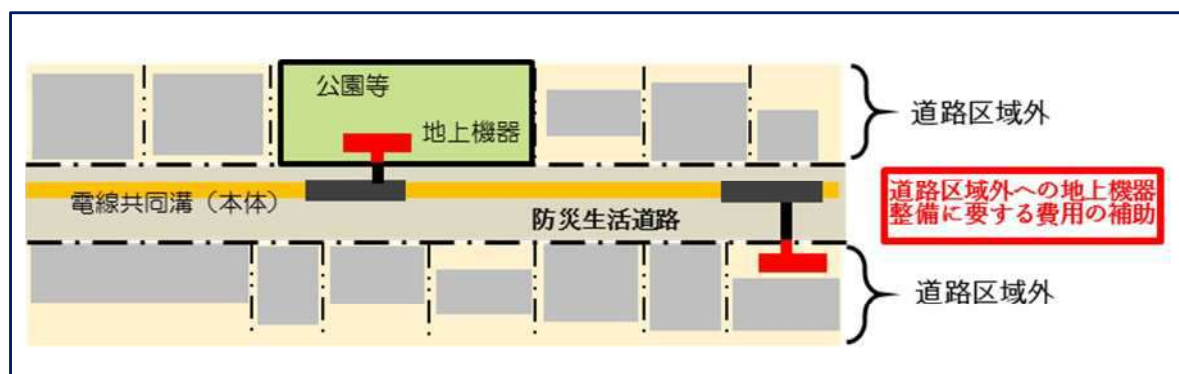
図IV-18 防災生活道路機能維持事業の補助対象のイメージ（平面図）
