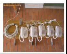
電話コードを延長ケーブルの回線端子に接続し、 受話器を上げて発信音の確認をして下さい
