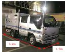
路面下空洞探査車
