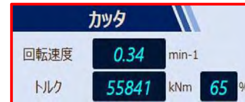
カッタートルクのリアルタイム監視状況
