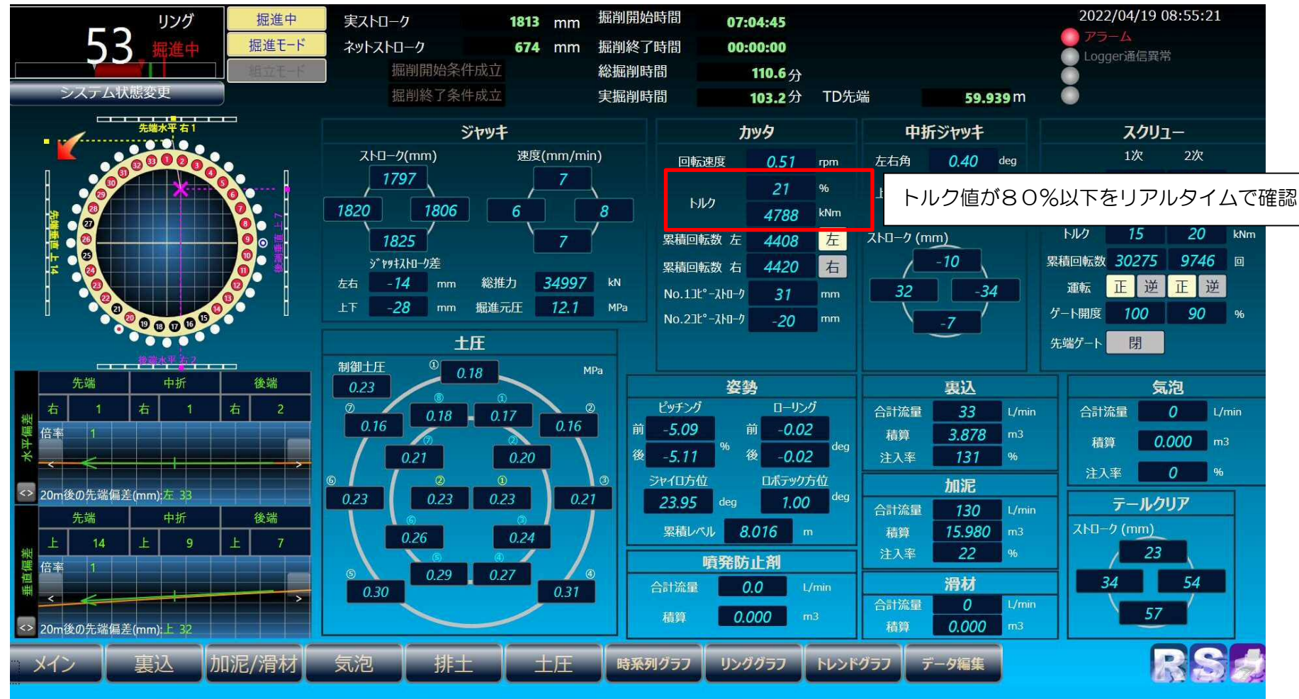
掘進管理システムでのリアルタイム監視状況（A ランプ 53 リングの例）
