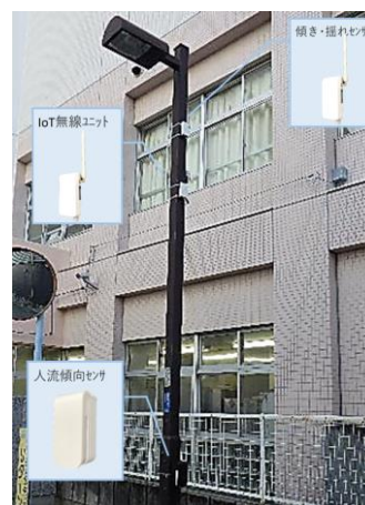
阿佐ヶ谷中学校に設置したIoT街路灯の実証実験(平成30年1月)
