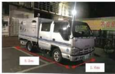
路面下空洞探査車(車載型レーダー)
