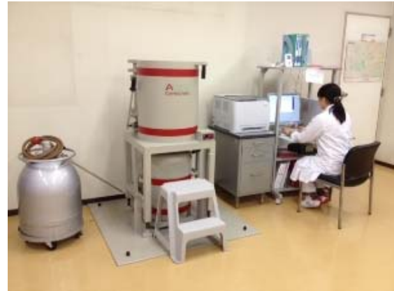
＜ゲルマニウム半導体検出器による測定＞
