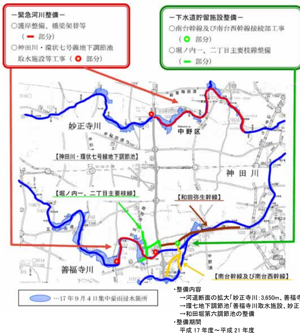
図 3-3 緊急河川整備及び下水道貯留施設整備 (出典：東京都 HP)
