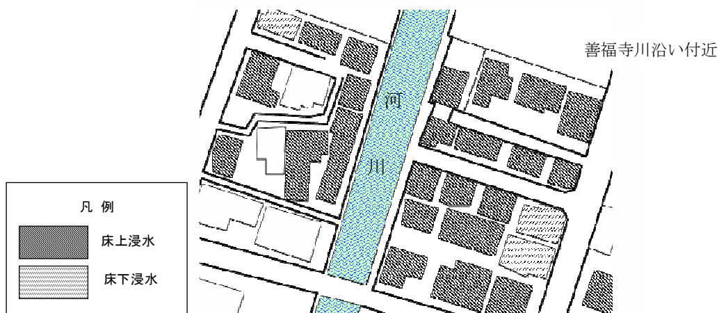
図3-9 内水氾濫と河川氾濫が同時に進行した建物被害の発生状況
